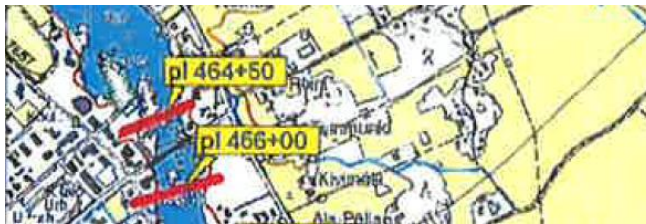
Kuva 9: Paalulukemat, joiden kohdalta tulvakorkeudet ja alimmat rakentamiskorkeudet on määritetty. Korkeuksien voidaan katsoa muuttuvan lineaarisesti kahden paalulukeman välillä.
