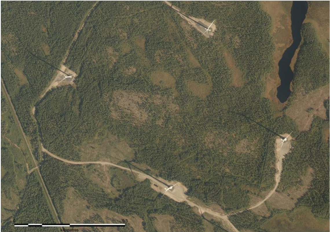
Kuva 70. Esimerkkikuva toiminnassa olevasta tuulivoimapuistosta. Tuulivoimaloita varten on rakennettu huoltotiet ja nostokentät. Tuulivoimaloiden ympäristössä ja välialueilla aikaisempi maankäyttö on säilynyt ennallaan.
