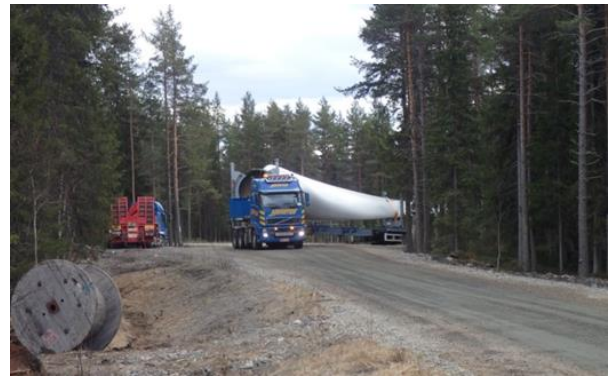
Kuva 76. Vasemmallä: Esimerkki tuulivoimapuiston rakennus- ja huoltotiestä. Maakaapeli sijoitetaan ojakaivantoon tien reuna-alueelle. Oikealla: Tuulivoimalan osia kuljetetaan erikoiskuljetuksina. (Kuvat: FCG).
