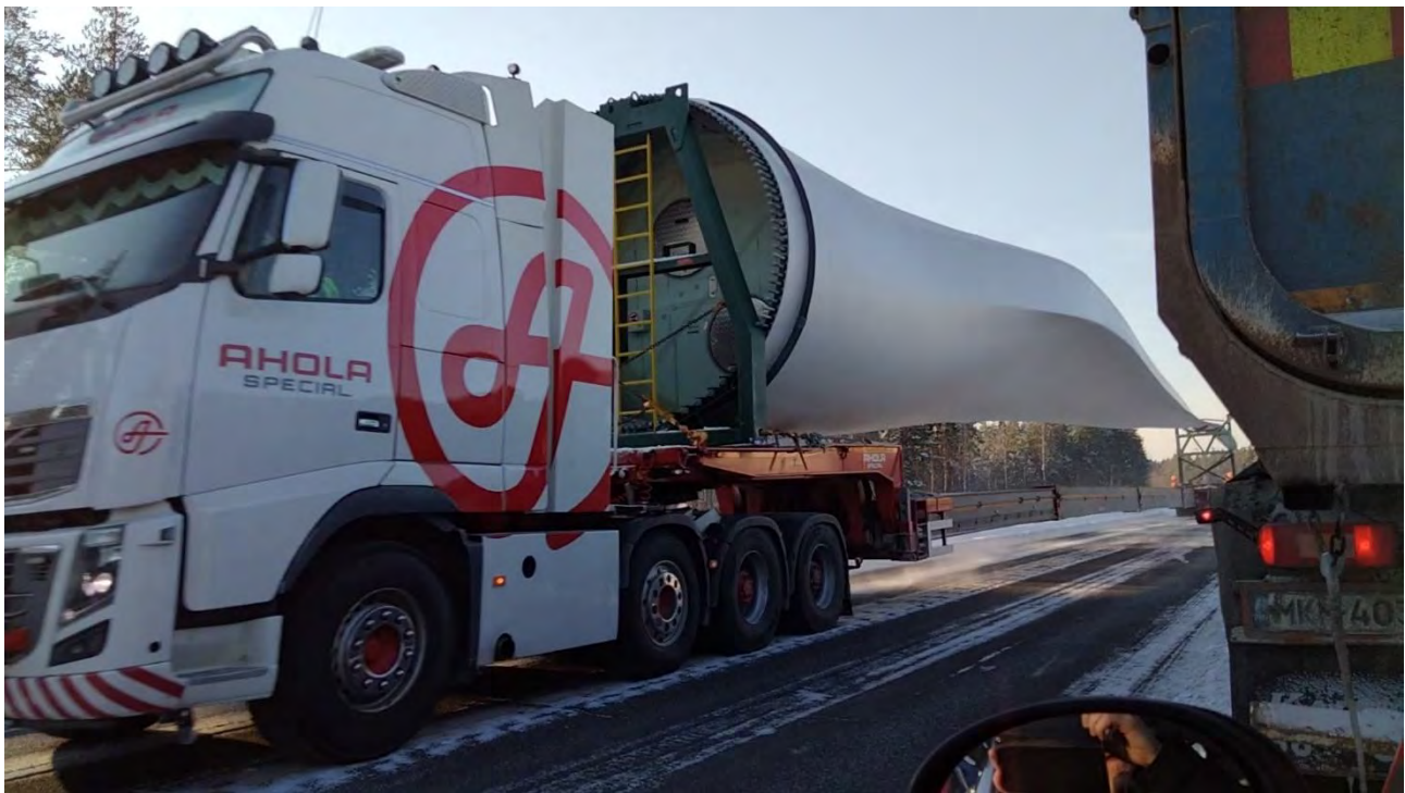
Kuva 47: Tuulivoimalan lavan kuljetusta
